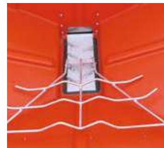
Miscelatore a scala combinato con il movimento del dosatore che tiene mescolato il contenuto
