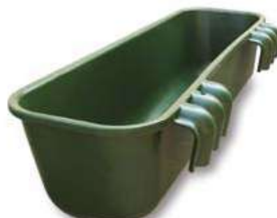
607 AK3268 L 100 X P 35 X H 24 cm - 42 l - Mangiatoia da appendere lunga 100 cm in plastica estremamente resistente rinforzata con fibra di vetro. Passanti superiori per aggancio, con possibilità di fissaggio a qualsiasi dispositivo fino a uno spessore di 50mm. Dimensioni profondità senza staffe di sospensione 28 cm.
