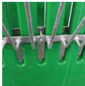
Fissaggio per tenere ancorata la mangiatoia alla parete
