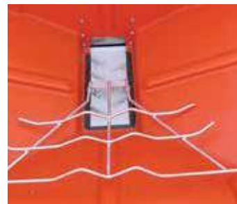
Miscelatore a scala combinato con il movimento del dosatore che tiene mescolato il contenuto
