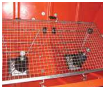
Miscelatore a scala combinato con il movimento del dosatore che tiene mescolato il contenuto
