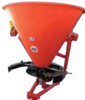
607 DE35301 • CAPACITÀ 430 LITRI / 330 KG • PESO 55 KG • DISTRIBUZIONE 1 - 16 METRI • ATTACCO A TRE PUNTI STANDARD • IMPIANTO DI ILLUMINAZIONE E LAMPEGGIANTI • TRASMISSIONE CARDANICA
