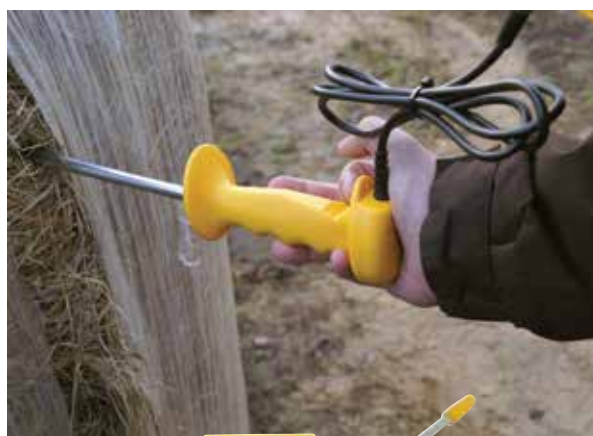
607 AK29356 Rilevatore umidità temperatura fieno e paglia
