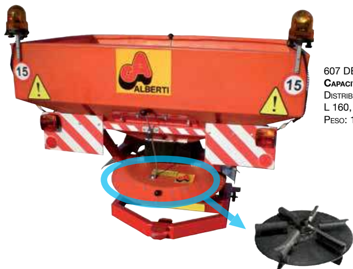
607 DE35313 • CAPACITÀ 430 LITRI / 330 KG • DISTRIBUZIONE 1 - 16 METRI • ATTACCO GANCIO DI TRAILO E TRATTORE • DISTRIBUZIONE AZIONABILE TRAMITE LEVA • IMPIANTO DI ILLUMINAZIONE E LAMPEGGIANTI • VENTOLA DI DISTRIBUZIONE IN MATERIALE SINTETICO E LAMELLE IN METALLO.
