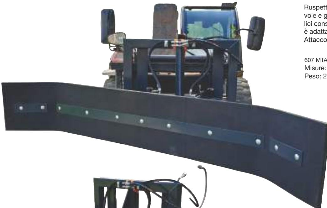
Ruspetta con struttura in acciaio molto solida e durevole e gomma telata molto resistente, I 2 pistoni idraulici consentono l'inclinazione sia a destra e sinistra ed è adatta a lavorare in qualsiasi ambiente. Attacco a 3 punti ed Euro per caricatori frontali
