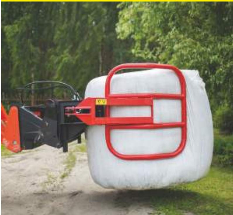
Pinza rotoballe per caricamento frontale con 2 cilindri idraulici. La forma ergonomica delle pinze, garantisce un trasporto sicuro delle rotoballe fasciate. La pinza non danneggia la pellicola durante il trasporto e il posizionamento della balla.
