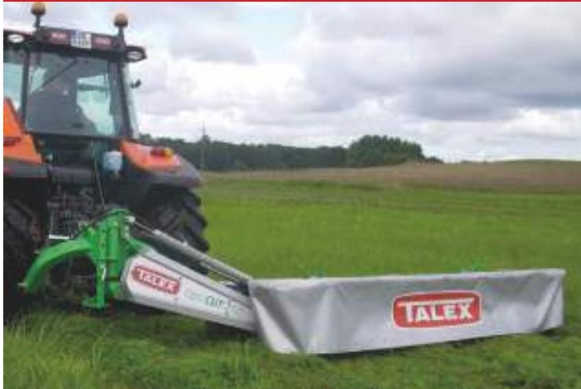
**Barra falciatrice Comer con dispositivo di sicurezza**, ogni disco è protetto da un dispositivo di protezione a spina di sicurezza - in caso di collisione, il disco viene disabilitato dal sistema di azionamento, riduce i costi di riparazione e le possibilità di guasti.
