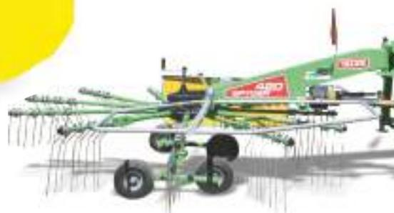
**Sistema di sterzo** • un sistema di due aste che consente un funzionamento regolare dell'angolo del sollevatore, fino a 20° sinistra/destra • bloccano il perno dello sterzo durante il trasporto
