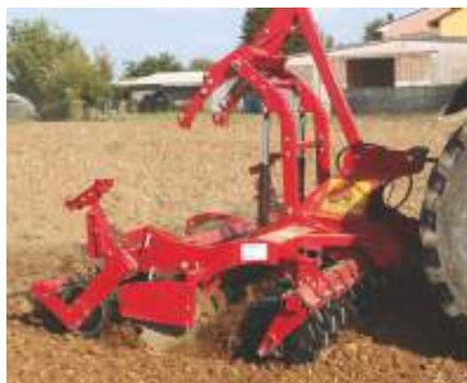
**Erpice a dischi 3m con dischi Ø 600, packer Ø 510, att. seminatrice + led**
