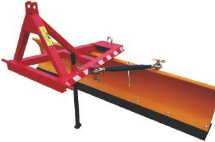
Ruspetta in acciaio zincato a caldo molto robusta. La gomma che appoggia a terra è rinforzata con cavi d'acciaio inerni. La regolazione d'inclinazione è da 0° a 360°. Il tirante destro/sinistro è manuale, come optional è possibile mettere un cilindro idraulico. Questa ruspetta essendo versatile è adatta per molteplici lavori.
