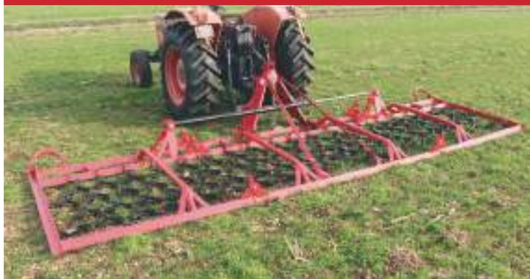
**607 AFU854/1-5M/4** Tipo di strigliatrice sospesa: **5m** con 4 file di denti in ghisa speciale / Larghezza di lavoro: 5,12 m / Dimensioni in posizione di lavoro lung.h x larg.h x alt.: 1,64x5,12x0,86 / Dimensioni di trasporto: 1,77x2,27x1,9 / Profondità di lavoro: 0,04 / Peso: 550 kg / Sistema di ripiegamento per trasporto: **idraulica** / Velocità di trasporto: max15
