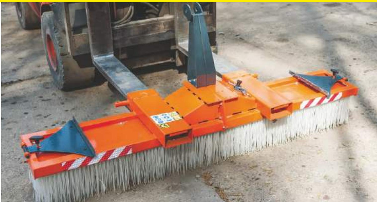
LA SPAZZOLA **SETOL BIG** È PRATICA, VELOCE E MOLTO EFFICACE PER LA PULIZIA DI QUALSIASI SUPERFICIE. LE SETOLE MOLTO SPESSO IN POLIPROPILENE DELLO **SPESORE DI 3MM** E LE GRANDE QUANTITÀ DI FILE ALTE 250 MM, RENDE QUESTA PULITRICE UNICA NEL SUO GENERE.
