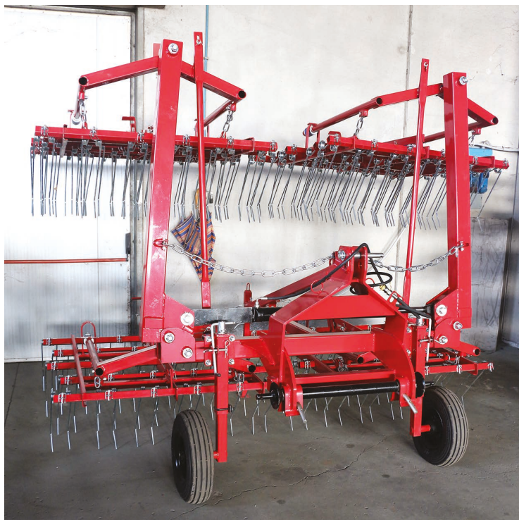
Ripiegamento idraulico delle sezioni laterali per la posizione di trasporto
