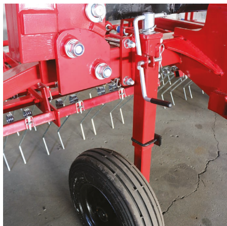
La ruota di supporto è regolabile a più altezze.
