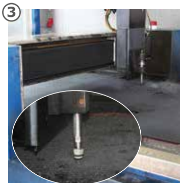
in base al disegno CAD vengono tagliate le feritoie o i fori esattamente su misura nei tappeti con l'innovativa tecnologia di taglio a getto d'acqua
