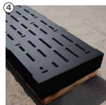
in base al disegno CAD vengono tagliate le feritoie o i fori esattamente su misura nei tappeti con l'innovativa tecnologia di taglio a getto d'acqua
