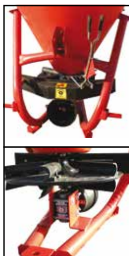
Miscelatore a scala combinato con il movimento del dosatore che tiene mescolato il contenuto
