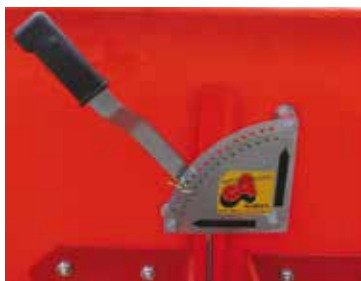
Regolazione di dosaggio a 15 stadi meccanica o idraulica di facile azionamento dalla cabina
