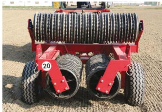
Rullo costipatore con dischi flottanti dentati in ghisa Ø 530/600mm, con cilindro ed impianto elettrico. Assicurano una compattazione ideale del terreno senza ondulate grazie ai diametri grandi dei dischi, donando un buon contatto tra terreno e semente/radice ed inoltre riducendo sensibilmente la porosità del terreno, evitando quindi un'eccessiva evaporazione dell'acqua in caso di siccità.
