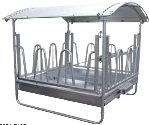
Mangiatoia da **12 e 14** posti in acciaio zincato a caldo, con pavimento e tetto. Lati apribili per introdurre il ballone lateralmente. Altezza pavimento da terra ca.35 cm. Piedi di appoggio a pattino regolabili in altezza per 10 cm. Telaio di protezione intorno al tetto in tubo di acciaio Ø 25 mm. Tubo 50x50x2mm come rinforzo sotto la base. Compresa di attacco a tre punti e di barra di supporto per gli spostamenti. Kit mont. compreso.
