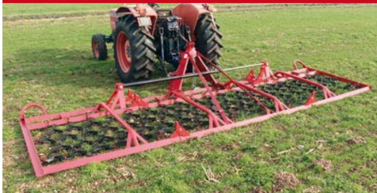
**607 AFU584-5M/4** Tipo di strigliatrice sospesa: **5m** con 4 file di denti in ghisa speciale / Larghezza di lavoro: 5,12 m / Dimensioni in posizione di lavoro lung.h x larg.h x alt.: 1,64x5,12x0,86 / Dimensioni di trasporto: 1,77x2,95x1,9 / Profondità di lavoro: 0,04 / Peso: 550 kg / Sistema di ripiegamento per trasporto: **idraulica** / Velocità di trasporto: max15
