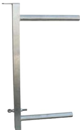
Elemento terminale per rastrelliere. Completo di tirante a vite per l'allineamento orizzontale. Verticale 60x60 mm, orizzontali Ø 51mm.
