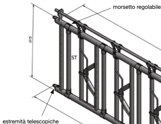
Rastrelliera in acciaio zincato a caldo con sistema di sicurezza per evitare l'impiccagione accidentale. Sistema di chiusura automatica. Estremità telescopiche regolabili per facilitare la lunghezza degli attacchi.
